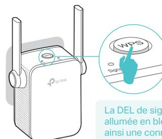
La DEL de signal doit rester allumée en bleu, indiquant ainsi une connexion réussie. Sinon utiliser l'option DEUX.
